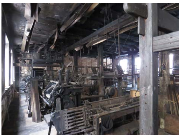
Ohořelé původní tkalcovské stroje v 2.NP
